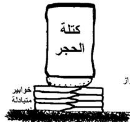
شكل (7) تصور لطريقة البناء وتثبيت الكتل المجاورة، شكل (8) الهزاز - أحد ودائع أساس معبد حتشبسوت - الدير البحري وبالمثل تثبيت كتل الصف الثاني وطبقة الملاط
